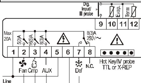
**ПРИМЕЧАНИЕ:** В соответствии с моделью реле компрессора - 8(3)A или 16(6)A.
