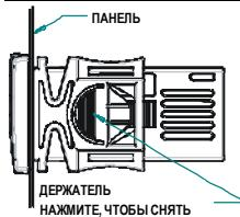
Контроллер XR70CX должен монтироваться на вертикальной панели в вырез 29x71мм и закрепляться, используя поставляемые специальные держатели. Диапазон температур, разрешенный для правильной эксплуатации - 0+60°C. Избегайте мест, подверженных сильной вибрации, с присутствием агрессивных газов, чрезмерной запыленностью или влажностью. Те же рекомендации применяйте и к датчикам. Позвольте воздуху циркулировать через отверстия для охлаждения.
