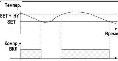
При неисправности датчика термостата, пуск и остановка компрессора осуществляется по времени согласно параметров "COH" и "COF".
