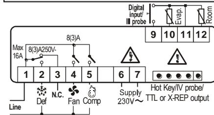
**ПРИМЕЧАНИЕ:** В соответствии с моделью реле компрессора - 8(3)А или 16(6)А.
