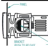
Контроллер XR60CH должен монтироваться на вертикальной панели в вырез 29x71мм и закрепляться, используя поставляемые специальные держатели.
